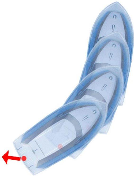
La barca in questo caso non viene “spinta” ma “tirata” dal motore, e l’asse di rotazione coincide con la posizione dell’elica.
